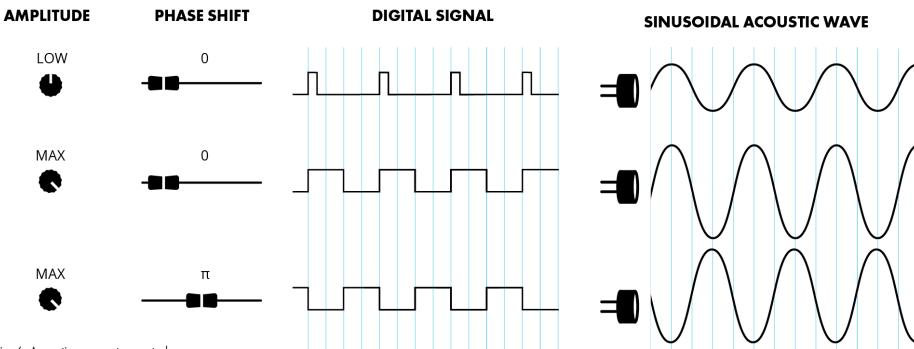
Fig. 6: Acoustic parameter control.
